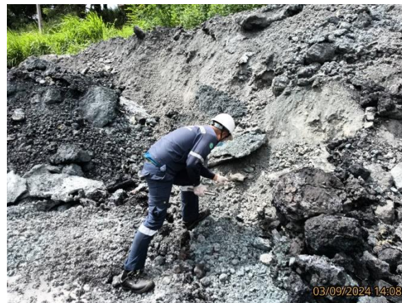
รูปที่ 4-54 เก็บตัวอย่างกากของเสียบริเวณที่กอง Slag จุดที่ 3 เก็บตัวอย่างในวันที่ 3 กันยายน 2567
