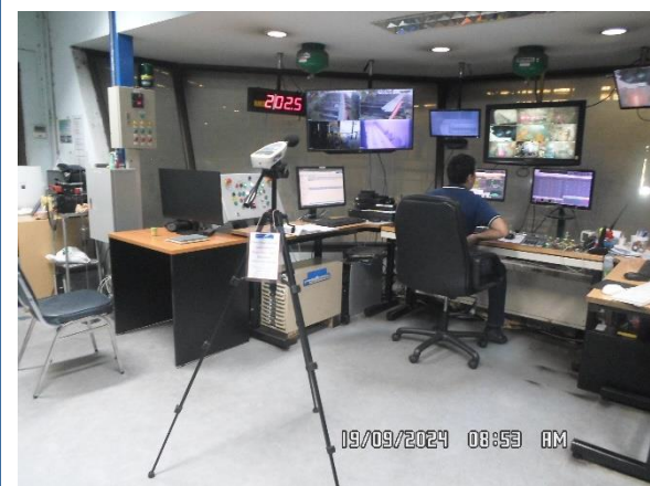
รูปที่ 4-57 ตรวจวัดระดับเสียงภายในห้องควบคุมของโรงรีด 2 ตรวจวัดในวันที่ 19 กันยายน 2567
