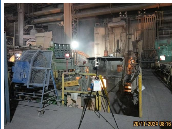
รูปที่ 4-69 ตรวจวัดคุณภาพอากาศบริเวณห่างจากเตาหลอม LF ประมาณ 10 เมตร เก็บตัวอย่างในวันที่ 20 พฤศจิกายน 2567
