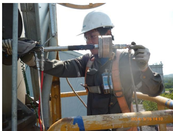
รูปที่ 4-46 ตรวจวัดคุณภาพจากปล่องระบายอากาศของโรงรีด 2 ตรวจวัดในวันที่ 16 กันยายน 2567
