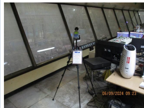
รูปที่ 4-56 ตรวจวัดระดับเสียงภายในห้องควบคุมของโรงรีด 1 ตรวจวัดในวันที่ 6 กันยายน 2567
