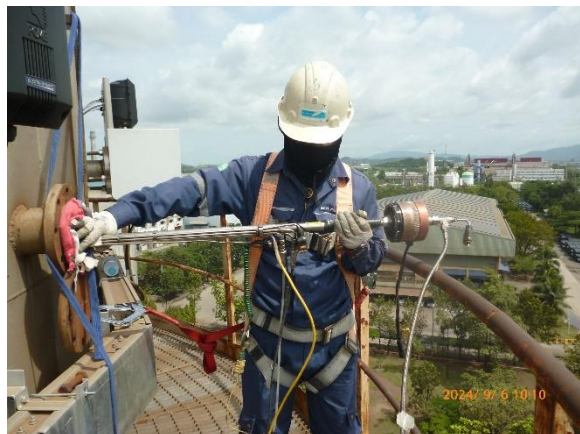
รูปที่ 4-44 ตรวจวัดคุณภาพจากปล่องระบายอากาศของโรงหลอม ตรวจวัดในวันที่ 6 กันยายน 2567
