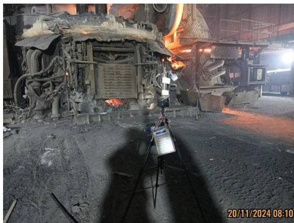
รูปที่ 4-66 ตรวจวัดคุณภาพอากาศบริเวณเตาหลอม EAF เก็บตัวอย่างในวันที่ 20 พฤศจิกายน 2567
