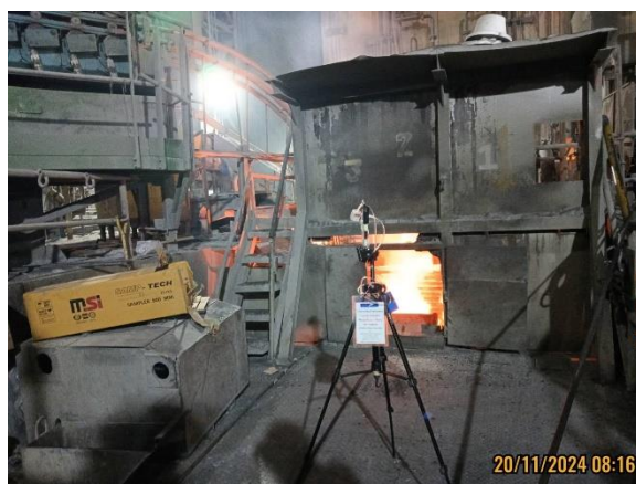
รูปที่ 4-68 ตรวจวัดคุณภาพอากาศบริเวณเตาหลอม LF เก็บตัวอย่างในวันที่ 20 พฤศจิกายน 2567
