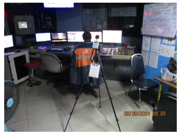
รูปที่ 4-55 ตรวจวัดระดับเสียงภายในห้องควบคุมของโรงหลอม ตรวจวัดในวันที่ 6 กันยายน 2567
