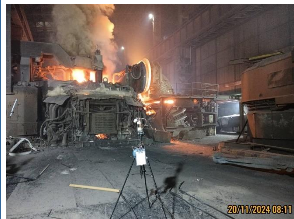
รูปที่ 4-67 ตรวจวัดคุณภาพอากาศบริเวณห่างจากเตาหลอม EAF ประมาณ 10 เมตร เก็บตัวอย่างในวันที่ 20 พฤศจิกายน 2567
