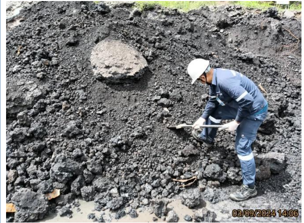
รูปที่ 4-53 เก็บตัวอย่างกากของเสียบริเวณที่กอง Slag จุดที่ 2 เก็บตัวอย่างในวันที่ 3 กันยายน 2567
