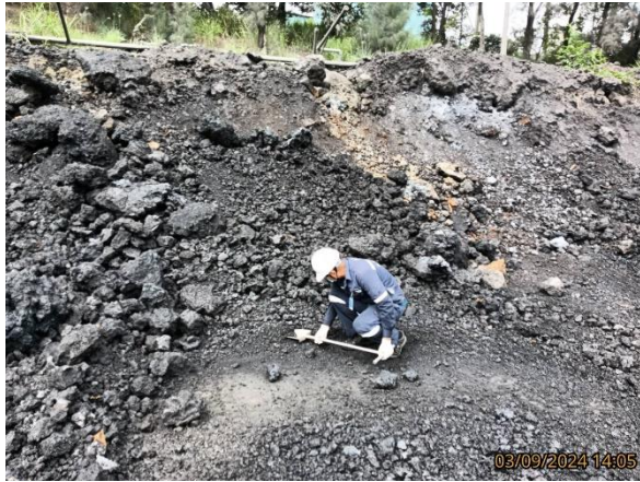
รูปที่ 4-52 เก็บตัวอย่างกากของเสียบริเวณที่กอง Slag จุดที่ 1 เก็บตัวอย่างในวันที่ 3 กันยายน 2567
