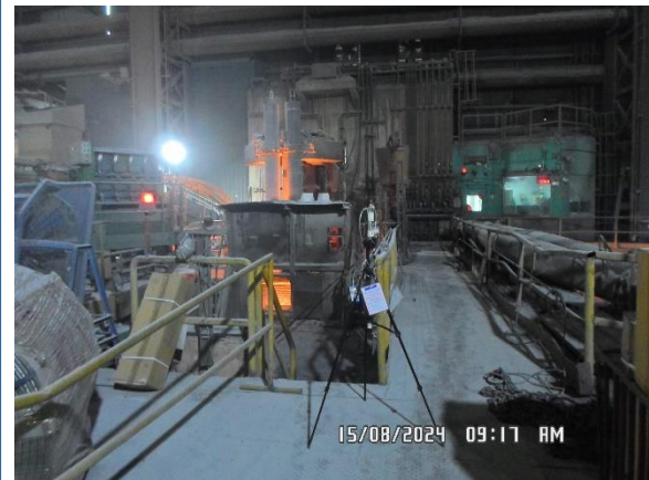
รูปที่ 4-65 ตรวจวัดคุณภาพอากาศบริเวณห่างจากเตาหลอม LF ประมาณ 10 เมตร เก็บตัวอย่างในวันที่ 15 สิงหาคม 2567
