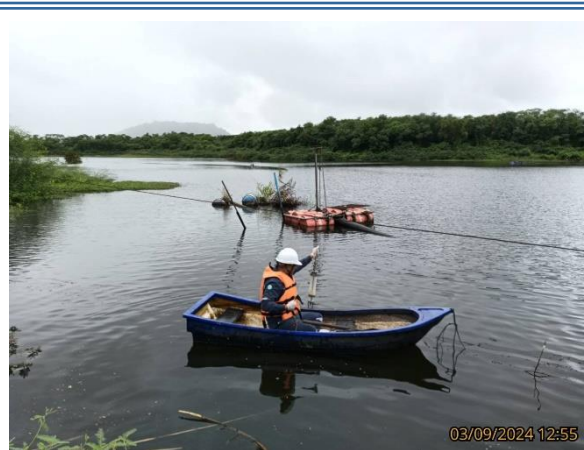
รูปที่ 4-47 แสดงการเก็บตัวอย่างคุณภาพน้ำผิวดิน บริเวณอ่างเก็บน้ำของบริษัท เก็บตัวอย่างในวันที่ 3 กันยายน และ 20 ธันวาคม 2567
