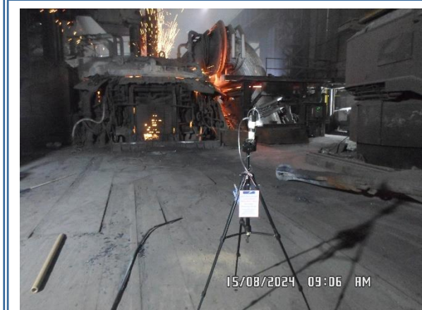
รูปที่ 4-63 ตรวจวัดคุณภาพอากาศบริเวณห่างจากเตาหลอม EAF ประมาณ 10 เมตร เก็บตัวอย่างในวันที่ 15 สิงหาคม 2567
